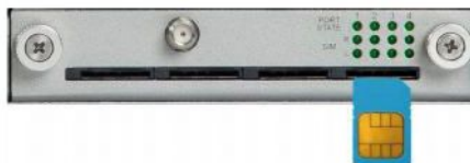
Рис.: Извлечение SIM-карты из сотовой платы.
