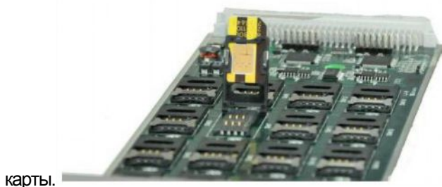
Рис.: Как вставляются SIM-карты в плату SIM-сервера.
